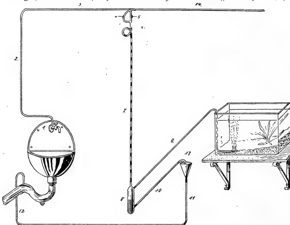
habe keinerlei Wartung oder Reparatur nötig. Die kleinste Umdrehung der Schraube bei 1 bringt stärkere oder schwächere Durchlüftung.
